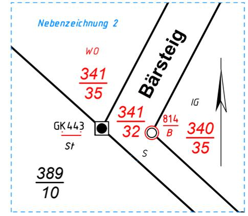
St schief an Mauer einbetoniert --> nicht korrigierbar --> Kreuz unkenntlich gemacht
